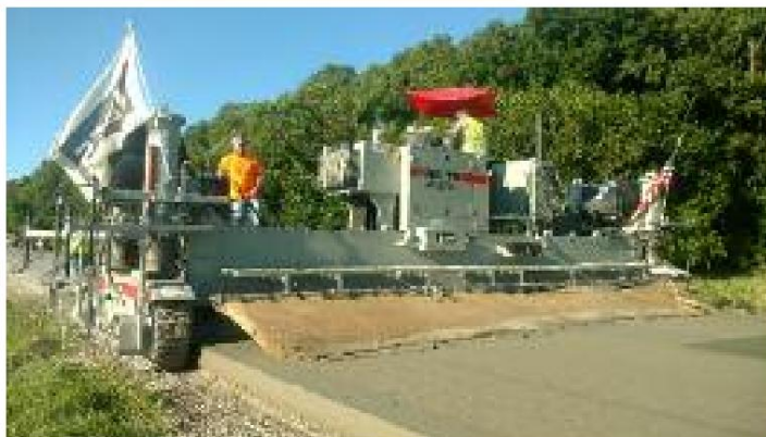
s Pavimentadoras Power Pavers SF-1700 y SF-2700 Pavimentadoras de encofrado deslizante
