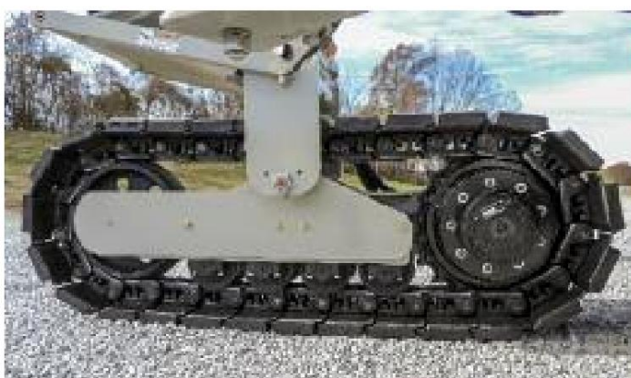
Primer plano de los rastreadores de paquetes MAX con almohadillas de poliuretano.
