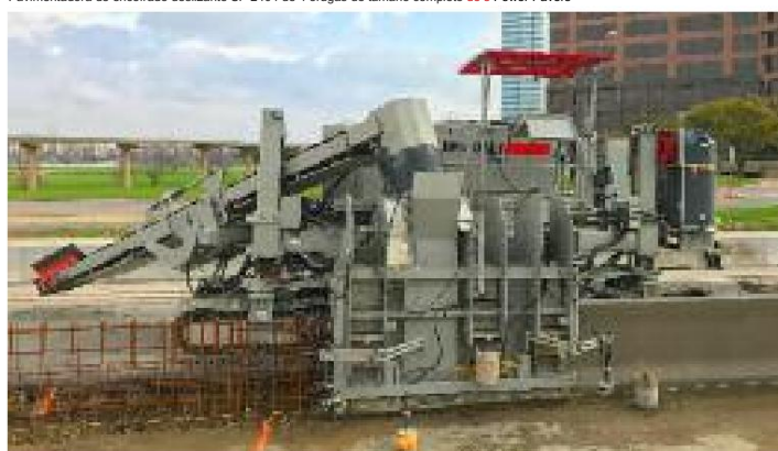
s Power Curbers 7700 Máquina de encofrado deslizante multiusos Vertido de barrera variable
