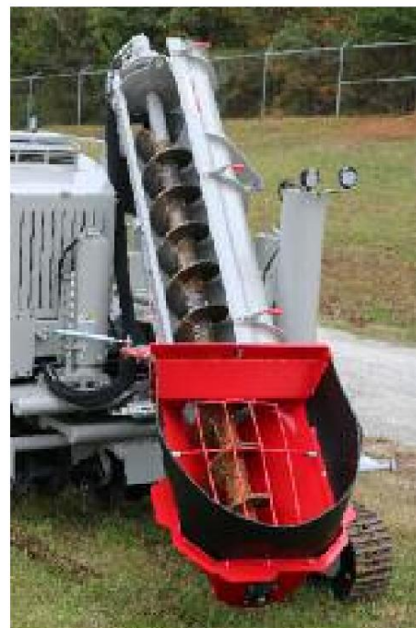
Transportador de barrena; la tapa se abre para limpieza.
