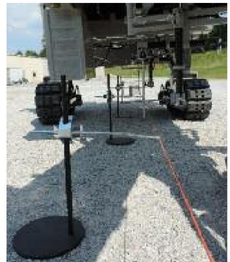
Montaje del sensor de parapeto.
